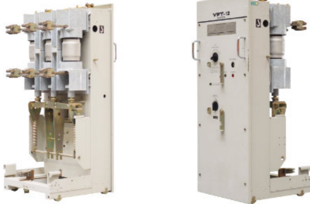
Bei Retrofit-Projekten entwickelt SZM Nachrüstlösungen, die exakt an die Stelle des alten Schaltwagens passen. Hier wurde ein alter Mittelspannungsschaltwagen Meiden VFT-12 durch einen extrem kompakten Schaltwagen mit einem HVX-Vakuum-Leistungsschalter von Schneider Electric ersetzt.
